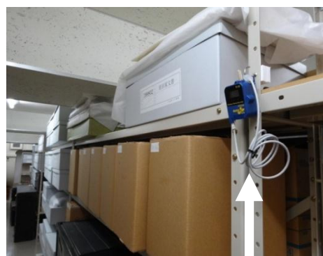
写真1 書庫に設置したデータロガー
