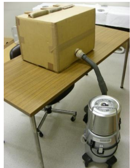
写真6 へパフィルター付掃除機を利用して作った集塵機
