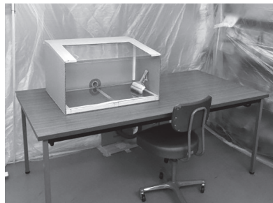
写真13 テント内の集塵機の本体
