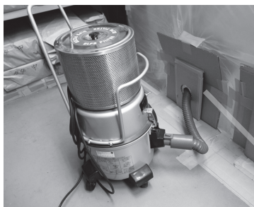
写真14 テント外の集塵機用掃除機
