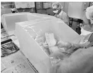
簡易ドライクリーニングボックスを使用した文書のドライクリーニング作業
