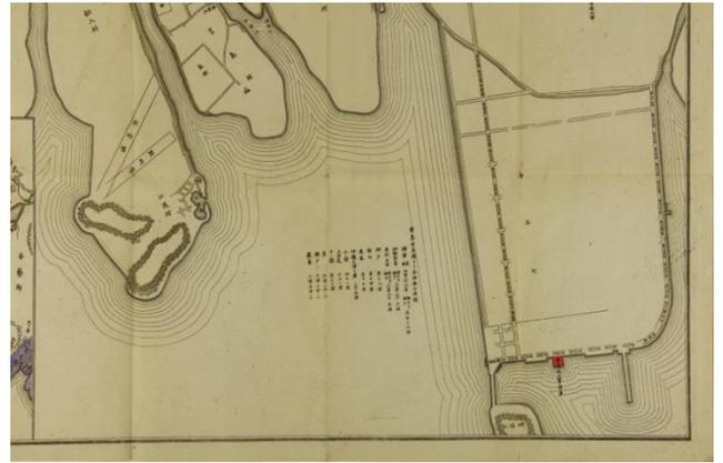
宇品築港後の状況。新開地と宇品島が接続し、港の東側に棧橋が築かれている。
