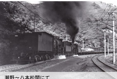
瀬野〜八本松間にて貨物列車を重連で後押しする補機の蒸気機関車
