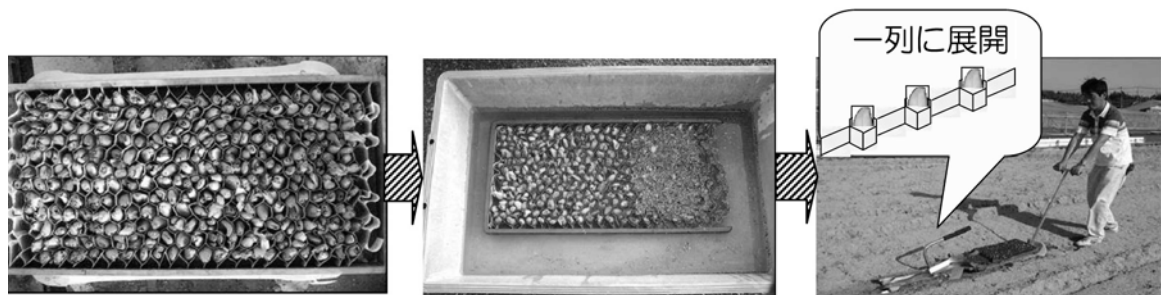
図1 開発した球根植付け機および連結ペーパーポットの概要
