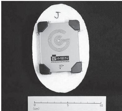
図1 加速度センサーを内蔵した発泡スチロール製の擬似レモン
