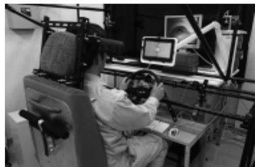
図6 タブレットを使った視線操作テストの様子
