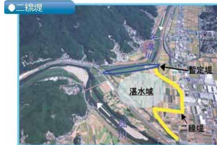
万一、本堤が決壊した場合に、被害を最小限にとどめる為、堤内地に築造される堤防。
