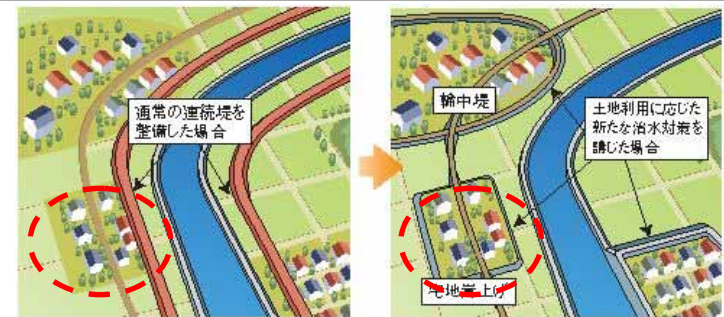
家屋の移転が必要となるなど完成までには多大な費用と期間が必要 輪中堤や宅地かさ上げを効率的に短期間で実施することにより、家屋の浸水被害を解消
