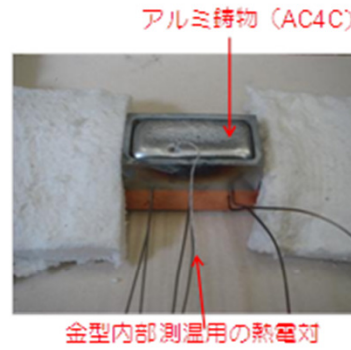
図4 鉄鋼-銅 金型を使った 重力铸造の様子
