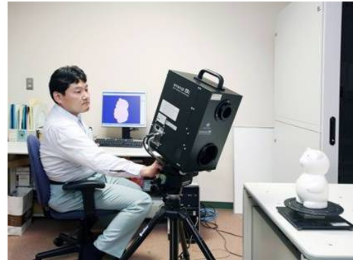
3Dデジタイザによる形状計測
