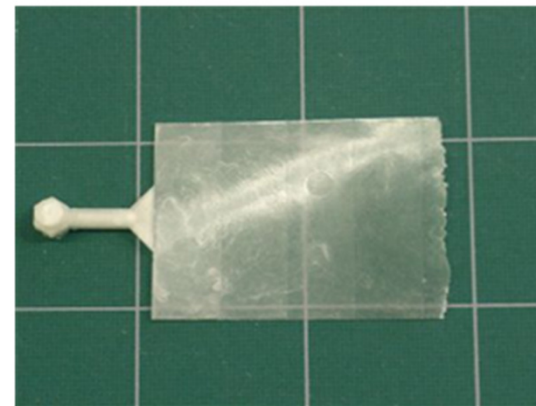
実際の射出成形結果 (4段目弱まで充填)
