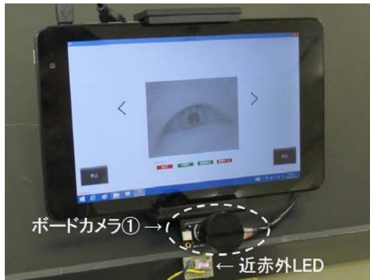
図8 タブレットを使った視線検出装置
