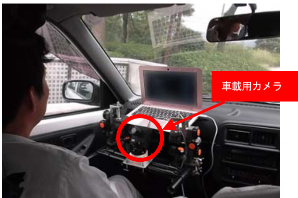
図6 車載用カメラでの視線検出実験
