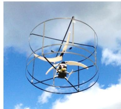
図8 保護フレームを取り付けた飛行実験
