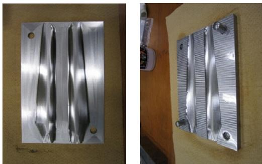
図7 製作したブレード金型
