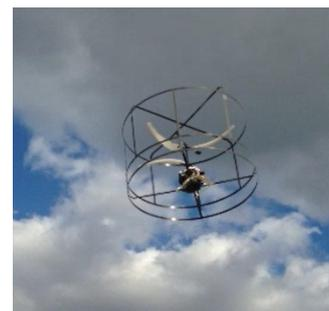
CFRP保護フレームを取り付けた飛行実験
