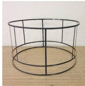
CFRP保護フレーム
