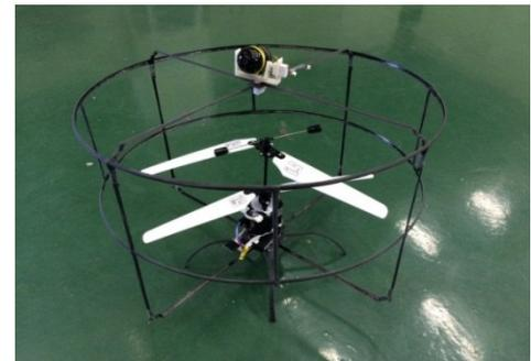
保護フレーム・カメラを取り付けた機体
