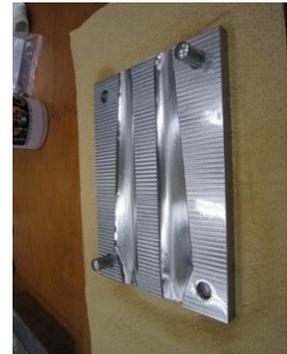
製作したブレード金型
