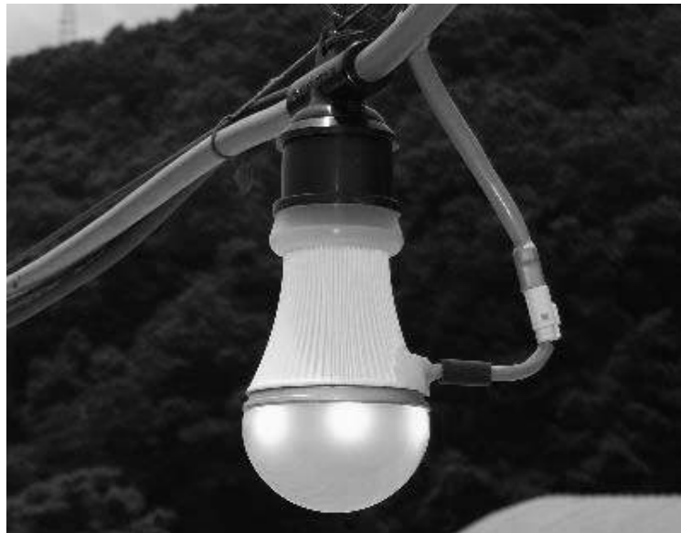
第 1-30 図 試作した明期 20 ms/暗期 80 ms の時間構造を有する黄色パルス光を放射できる LED ランプ
