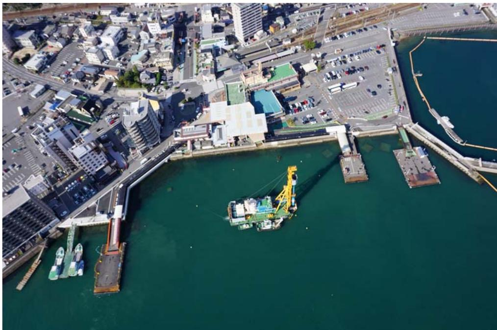
浮棧橋を撤去した水域で、深層混合処理船による地盤改良を実施しています。
