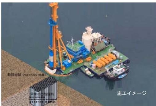
改良材と海底の土を混合し、地盤を改良します。
