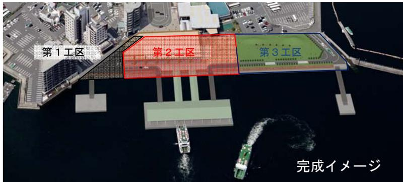
10月末までに、フェリー棧橋の移設を全て完了し、現在は2工区と3工区にまたがる区域において、深層混合による地盤改良を実施しています。年内に深層混合処理を完了させ、年明けには2工区埋立工事の床掘に着手する予定としています。
