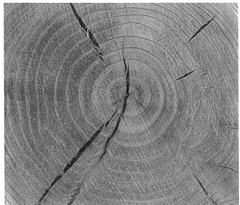
内部割れが発生したスギの木口断面
