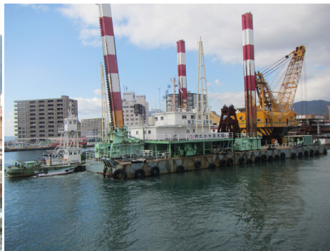
浚渫船は赤白のスパット杭で固定しています。
