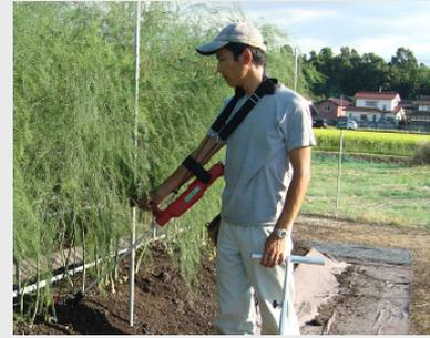
2. 若茎にハサミを挿し入れてスイッチを押すと、若茎を切断します。
