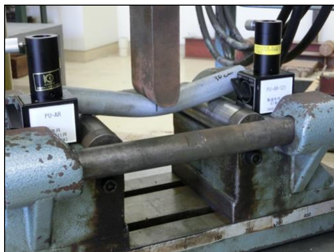
図 8 曲げ試験の様子 (島津製作所製 UH-F500kNI)
