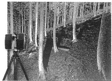
写真1 レーザースキャナとデータ
