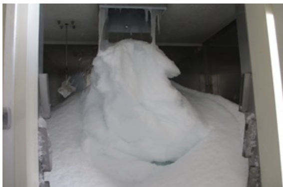
専用の製氷機により作られた海水氷(フレーク状)
