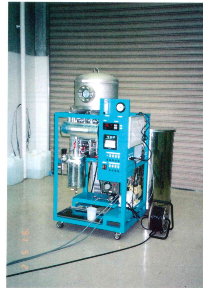
試作した透過気化ミニプラント
