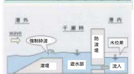
海水交換型防波堤により循環流（1方向流）を発生させ港内の海水交換を促進させる。
