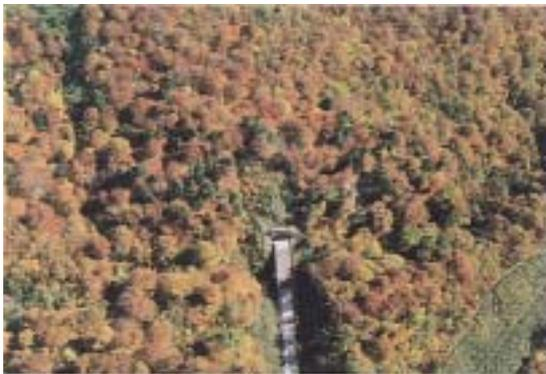
【トンネルの採用により切り開く範囲を抑制】
