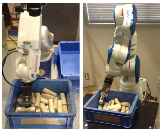
6軸ロボット(デンソーウェーブ製) 7軸ロボット(安川電機製)
