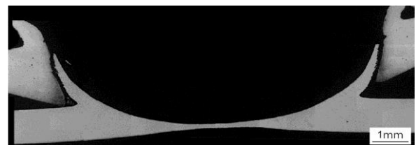
図7 十字引張試験後の接合試料断面状態（押し込み深さ 1.8mm）
