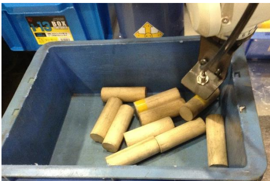
図8 円筒形状ワークのランダムピッキング
