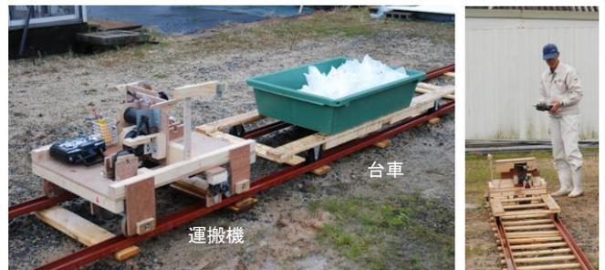
図4 試作運搬機とリモコン運搬の様子
