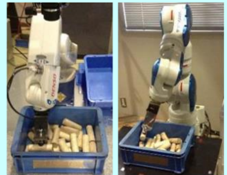
6軸ロボット (デンソーウェア製:2kg可搬) 7軸ロボット (安川電機製:20kg可搬)
