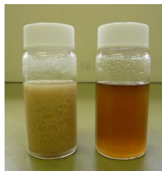
図4 クロロホルム溶媒に分散させた無処理の竹LCNFとオクタノイル化した竹LCNF
