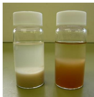
図5 テトラヒドロフラン溶媒に分散させた無処理の竹LCNFとオクタノイル化した竹LCNF
