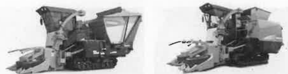
ワゴンタイプ ロールベアタイプ 汎用型微細断飼料収穫機
