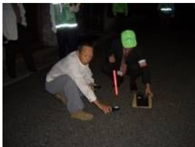
照度計を用いた暗がり調査
