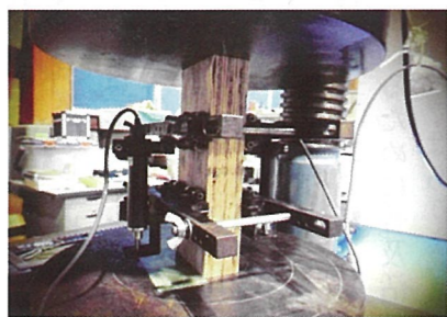
写真1 B種LVL縦圧縮試験
