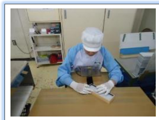
写真 3（やけど防止センサーが設置されている 手動角融着機での容器組立作業）
