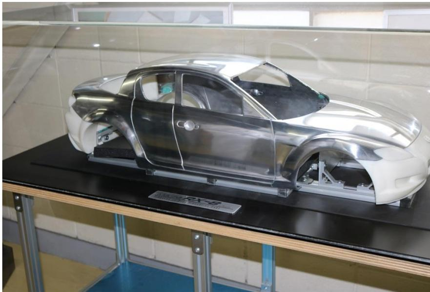
一枚の金属板から板金加工で作った5分の1スケールのRX-8
