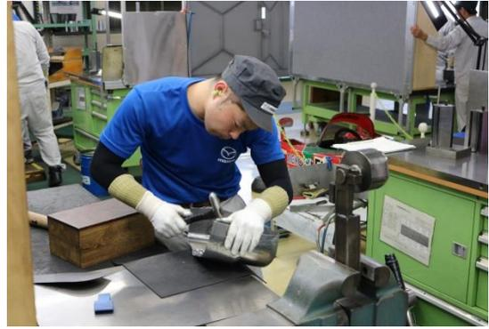
↑上図 伸ばし作業 ↓下図 絞り作業
