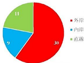
【護岸被災箇所特性】
