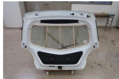
写真6 測定試料（ガラス部に空気層を付加した状態）
