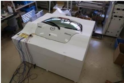
写真2 断熱評価装置の全体図
