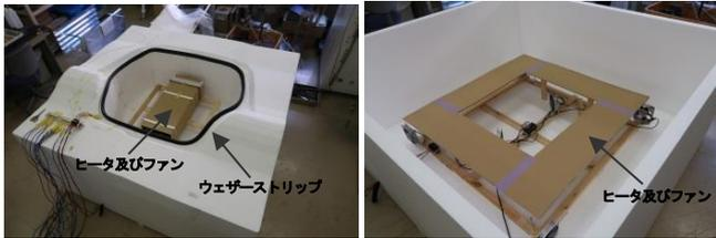
写真1 測定装置の内箱（左）と外箱（右）
