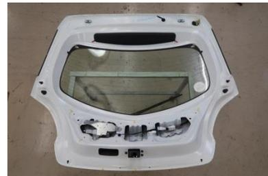
写真5 測定試料（内装トリムを外した状態）
