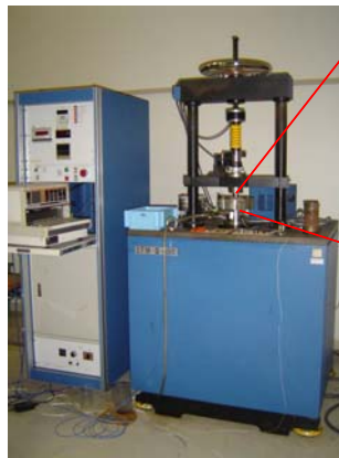
図1 摩擦摩耗試験機 (リング・オン・ディスク試験)
