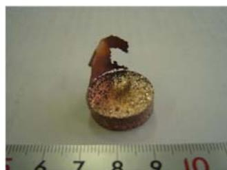
図2 溶融成形した銅-ダイヤモンド複合材料
