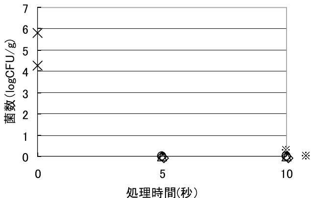
図5 過熱水蒸気処理によるスルメの菌数変化 ×, 初発菌数; △, 120°C処理; ◇, 140°C処理; ○, 160°C処理 初発芽胞数は300 (CFU/g) 以下 ※菌が不検出の場合、菌数を 10^0 とした。
