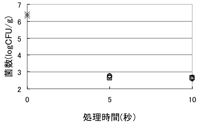
図6 過熱水蒸気処理によるチリメンの菌数変化 ×, 初発菌数; △, 120°C処理; ◇, 140°C処理; ○, 180°C処理 初発芽胞数は 7.4 \times 10^2 (CFU/g).
