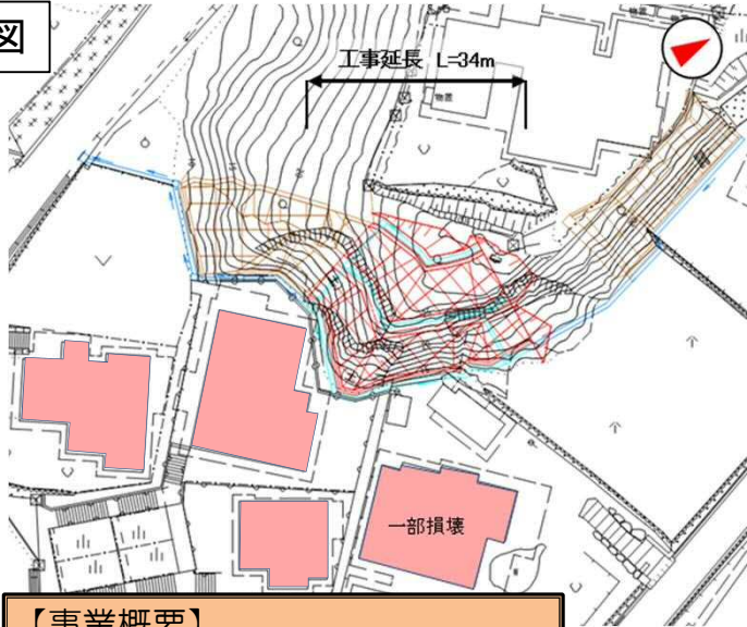
斜面崩壊・被災状況（H30年7月）
