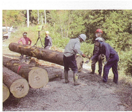
写真3 縦振動法を行う様子
