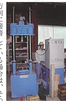
写真2 短柱圧縮試験機
