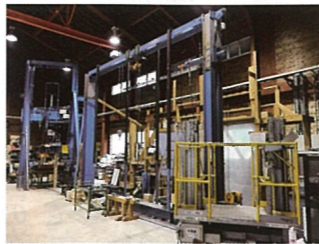
写真3 壁体せん断試験機と昇降機
