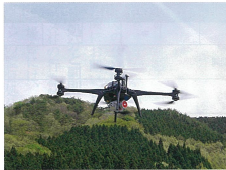
写真1 レーザースキャナを搭載したドローン
