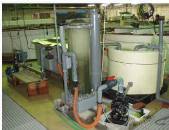
写真1 広島県に設置した普及型閉鎖循環飼育システム：5kL水槽
