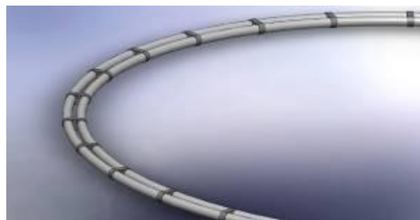
図1 PE管製かき養殖筏の設計案
