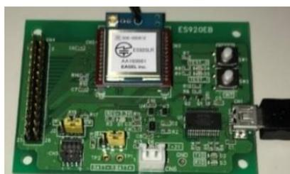
図6 LoRa通信評価ボード (ES920EB)
